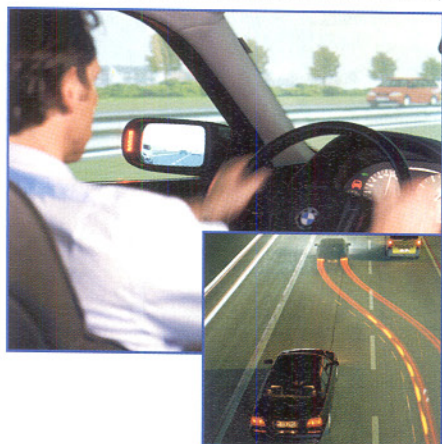
Bild 10: Schrecksekunde toter Winkel - moderne Sensorsysteme warnen den Fahrer vor dem Spurwechsel. Bild: BMW
