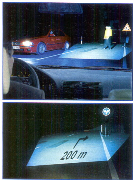
Bild 13: Könnte eine Revolution in der Scheinwerfertechnik werden: das Pixellicht. Es leuchtet wichtige Objekte mit beweglichen Minispielen gezielt an, Blendung des entgegenkommenden Fahrers wird vermieden und es lassen sich Fahrerinformationen direkt in den Lichtkegel einblenden. Bild: BMW
