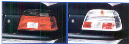
Bild 17: Flexible Lösung: Mit LED- und Lichtleittechnik können den Leuchtfeldern unterschiedliche Aufgaben je nach Situation zugeordnet werden. Bild: Hella KG
